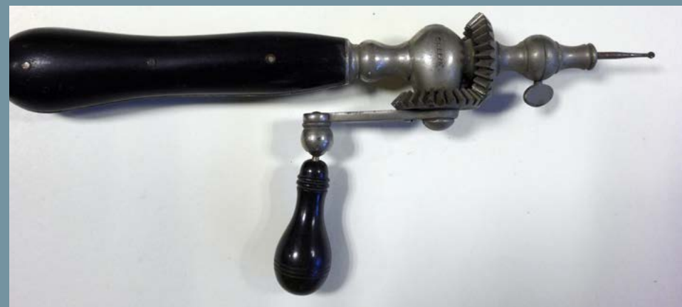
Fraise à manivelle, entraînement à cardan, par Collin, 2 e moitié du XIX e siècle. (Musée de l'Art dentaire de Garancière).
