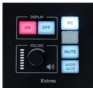
Démarrez le système en appuyant sur le **ON** de la TC Extron. Le pc fixe sera directement diffusé sur les écrans.
