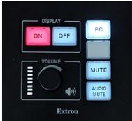
**Démarrer** le système en appuyant sur le **ON** de la TC Extron
